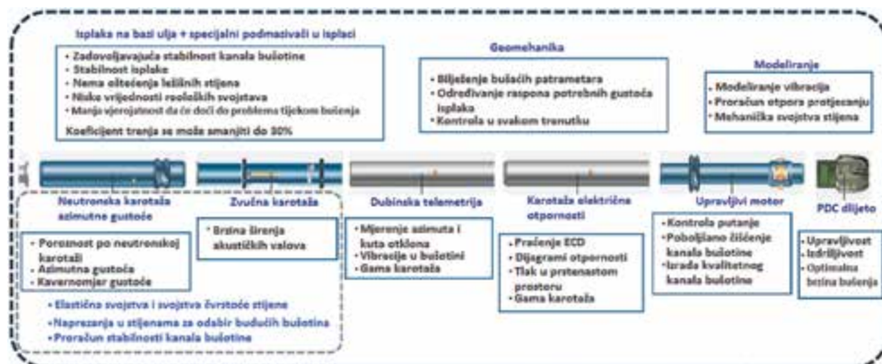
Slika 4 – Sklop za usmjerenno bušenje s osnovnim komponentama (Glebov et al., 2015)
