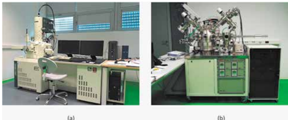
Slika 3 – FESEM (a) i SIMS uređaj u LFPM pri CMNZT u kampusu SvRi na Trsatu
