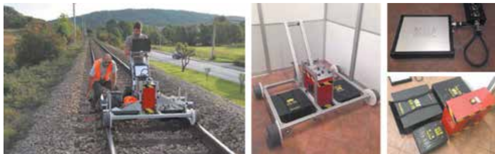
Slika 3 – Izrađena kolica i oprema (upravljačka jedinica i antene) za ispitivanje 182 km željezničkih nasipa u Hrvatskoj
