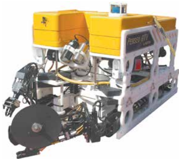
Slika 1 – Daljinski upravljano podvodno vozilo ( Remotely Operated Vehicle – ROV) višestruke namjene, koje prema konkretnom zadatku može biti opremljeno raznim alatima i dodacima
