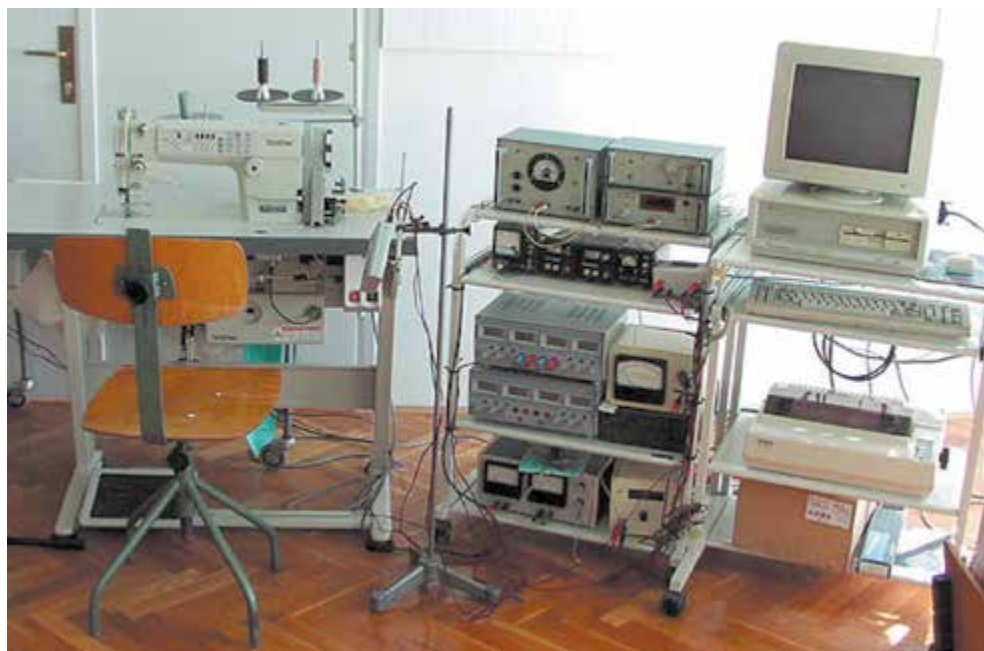
Slika 5 – Sustav za automatska mjerenja procesnih parametara i struktura tehnoloških operacija proizvodnje odjeće
