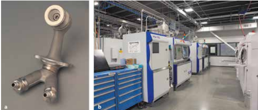
Slika 9 – a) Mlaznica za gorivo kod avionske turbine, b) Niz 3-D printera za serijsku proizvodnju mlaznica u GE-Aviation tvornici u Alabami, USA
