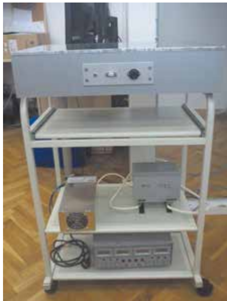
Slika 2 – Vruća ploča za mjerenje toplinskih svojstava kompozita
