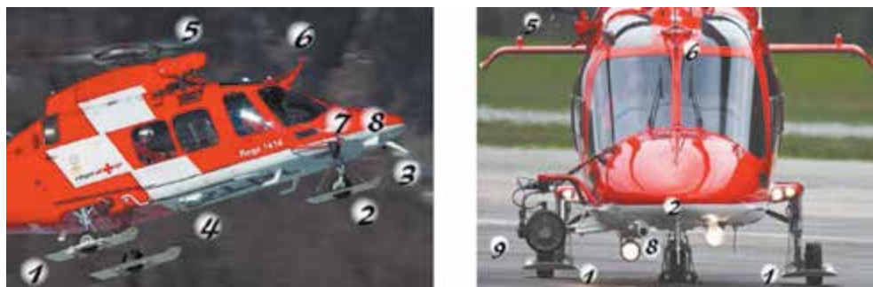
Slika 1 – Tehničke performanse helikoptera AW109 SP Grand New u konfiguraciji „Da Vinci“ Legenda: 1.-2. Fiksni stajni trap s gaznim površinama za meki teren ili snijeg, 3. Rezač kablova, 4. Sustav kuke 1.000 kg (sling), 5. Hiost 270 kg dizalica, 6. Rezač kablova, gornji, 7. Retrovizor za sling i hoist, 8. EVS kamera, 9. Nite Sun reflektor [2]
