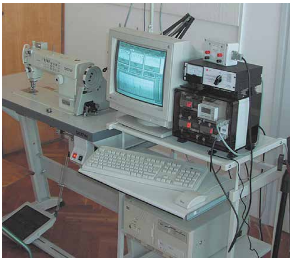
Slika 6 – Sustav za mjerenje energetske potrošnje električne energije šivaćih strojeva
