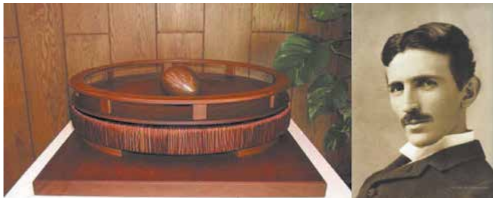
Slika 2 – Model stroja kojim je Nikola Tesla na Svjetskoj izložbi u Chicagu 1893. demonstrirao okretno magnetsko polje [7]
