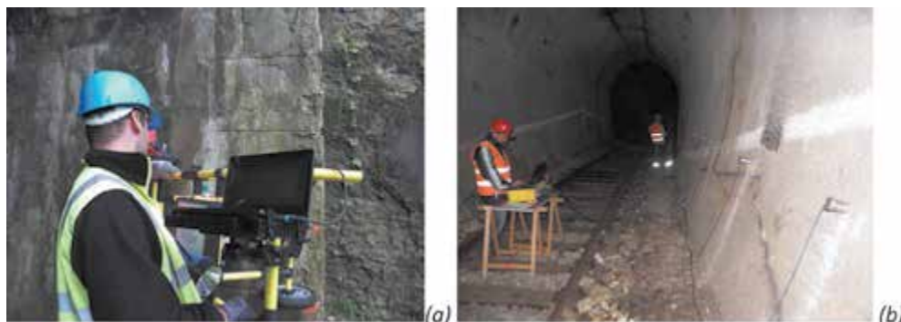
Slika 7 – Ispitivanje elektromagnetnom GPR metodom (a) i seizmičkom SASW metodom (b) (Kovačević i dr., 2015)
