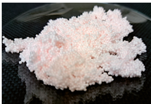
Slika 8: Emulzijski eksploziv smanjene gustoće
