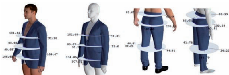
Slika 6: Mjerenje i analiza komocije na digitalnim prototipovima modela
