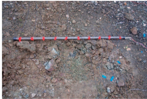
Slika 3: Postav mjerenja brzine detonacije u čeličnim cijevima.
