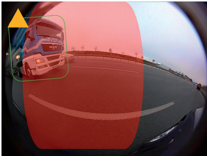
Slika 1: Prikaz detekcije vozila u mrtvom kutu
