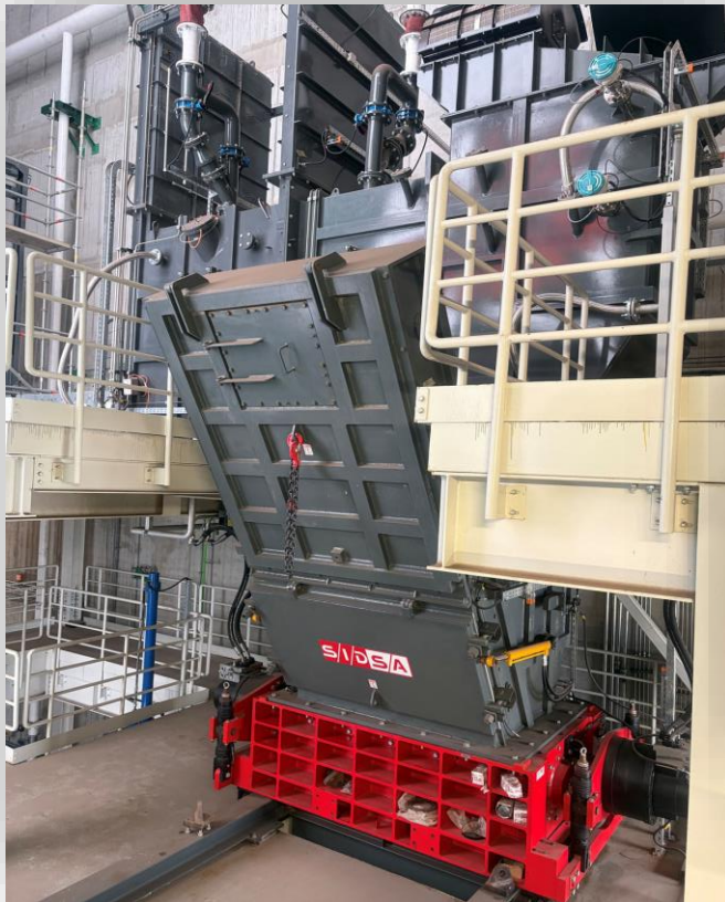
Komora za inertizaciju i šredovanje
