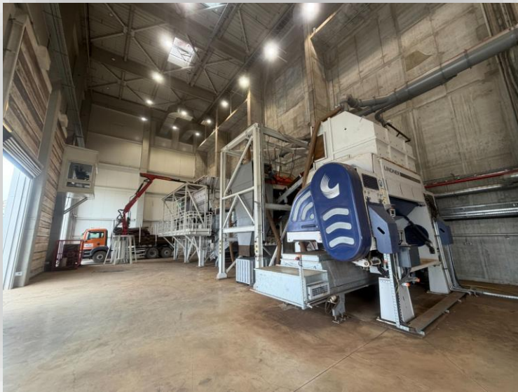
Primarni i sekundarni šreder Lindner
